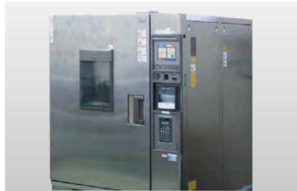
■ 恒温恒湿器 (-70~+100°C) TEMP. & HUMID CHAMBER (-70~+100°C)
