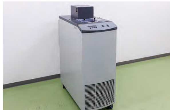
■ 大深度バス -80~110°Cの温度バス Deep-Well Baths Temperature: -80 to 110°C
